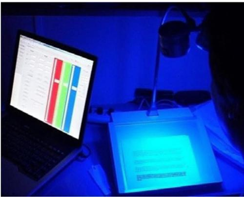
**Рис. 14.** Система для тестирования Orthoscopy Read Eye – Специальный прибор, имеющий наибольший цветовой диапазон по сравнению с аналогами, и компьютерная программа, являющиеся авторской разработкой, предназначенной для индивидуального определения оптимального зрительного стимула с целью компенсации нарушений обработки зрительной информации
