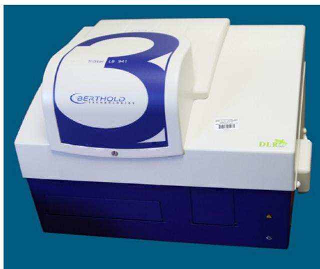
Рис. 1. Планшетный люминометр «TriStarLB 941» (Германия)
