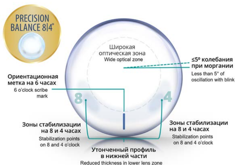
Рис. 1. Дизайн стабилизации Precision Balance 8/4 в торических линзах Alcon: модифицированный призматический балласт
