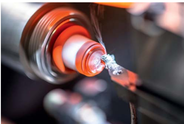
Рис. 3. Токарная обработка заготовки при изготовлении контактной линзы
