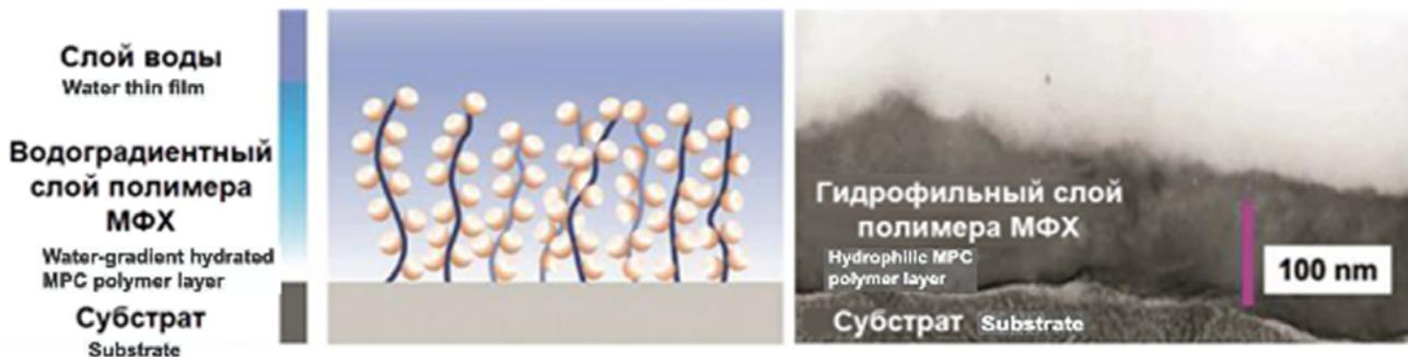
Рис. 4. Нанесение МФХ на поверхность. Изображение поверхности, полученное с помощью просвечивающей электронной микроскопии, показано справа
