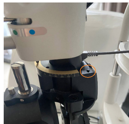
Рис. 10. Переключение в инфракрасный режим на блоке ЩЛ Fig. 10. Switching to infrared mode on the block of slit lamp
