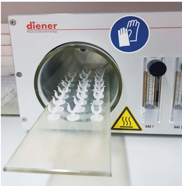
Рис. 3. Установка для плазменной обработки линз производства компании Diener Electronic, Германия
